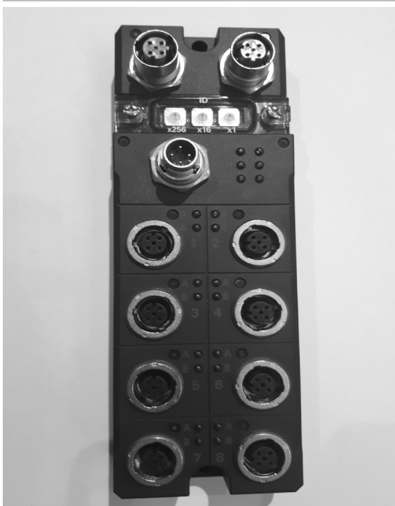
FIGURA 7 MAESTRO IO-LINK CON OCHO PUERTOS IO-LINK Y CONEXIÓN A BUS DE CAMPO ETHERCAT
